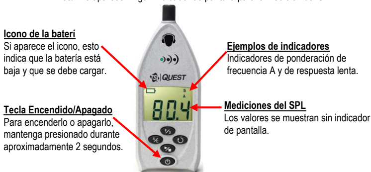
Figura 1-2: Visualización del nivel de presión de sonido (SPL)
