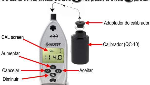
Figura 1-10: Calibração do SD-200
