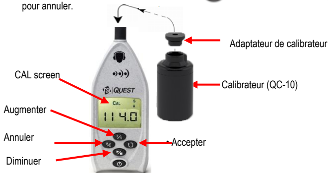
Figure 1-10 : Étalonnage du SD-200
