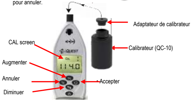
Figure 1-10 : Étalonnage du SD-200
