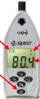
Figura 1-2: Visualización del nivel de presión de sonido (SPL)
