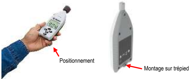
Figure 1-9 : Positionnement et montage sur trépied
